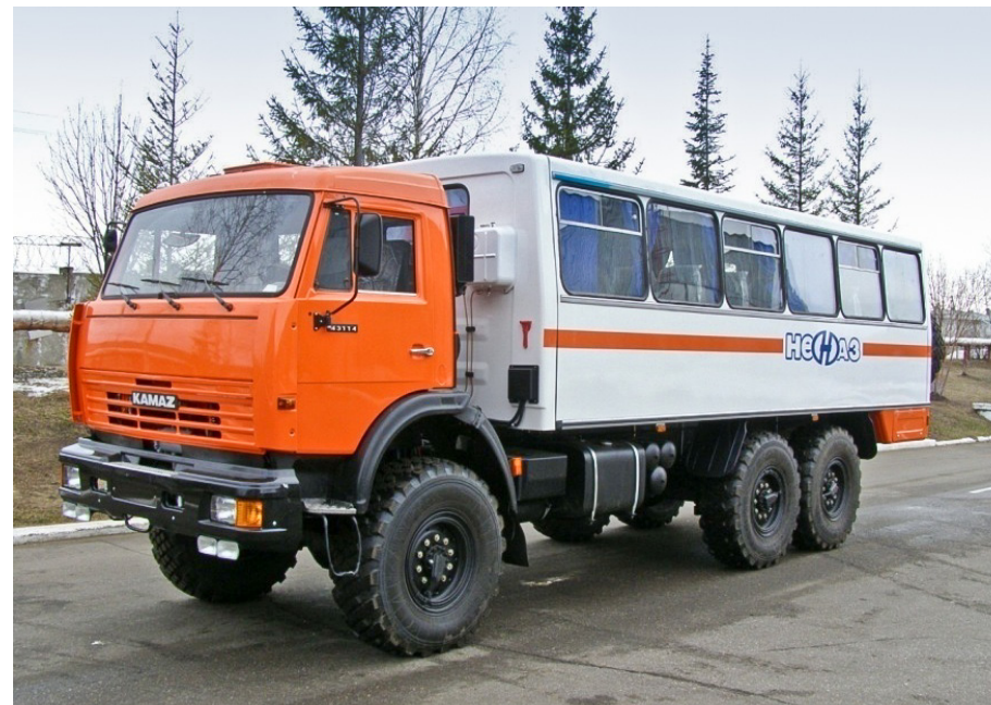
Вахтовый автомобиль НЕФАЗ-4208-30 на шасси КАМАЗ-43114 с базой 4100 мм, пассажироместимостью 28 человек - изготовлен опытный образец, проведены предварительные испытания, включая работы по сертификации. По результатам изготовления и испытания опытного образца дорабатывается конструкторская документация.
