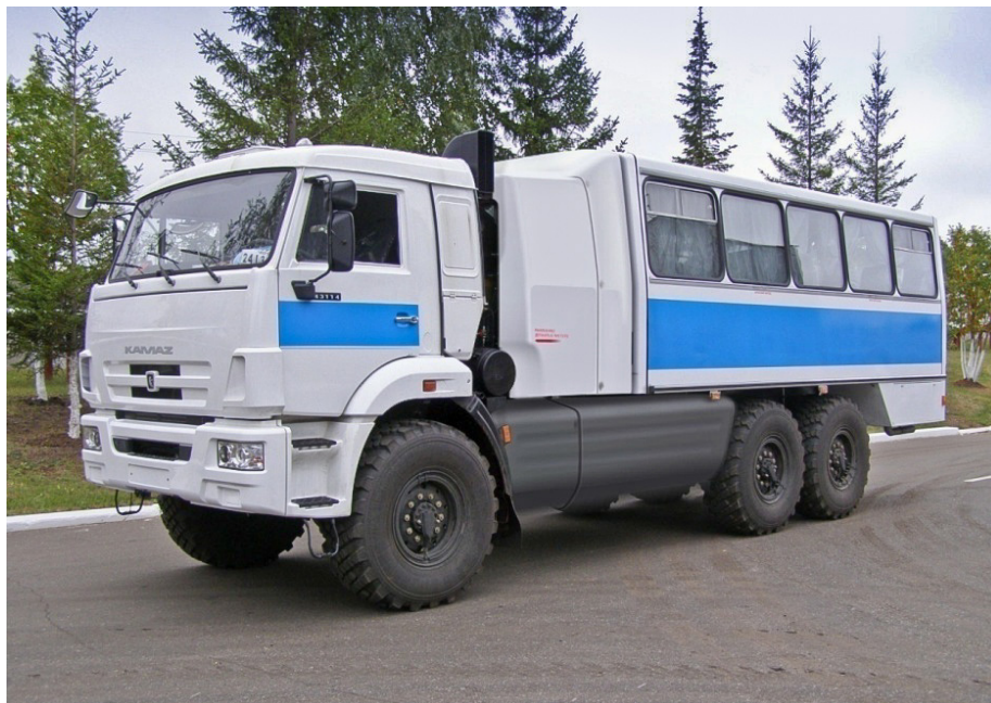
Вахтовый автомобиль НЕФАЗ-4208-41 на шасси КАМАЗ с газовым двигателем - проведены сертификационные испытания.
